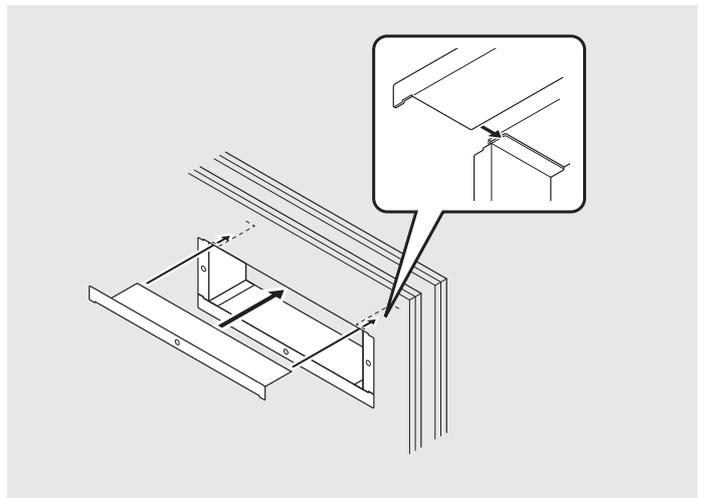
⑤ 天面板と側板Aとの切り欠き形状が一致するように合わせた後、付属のφ3.5×25Lタッピングビスで固定してください。
