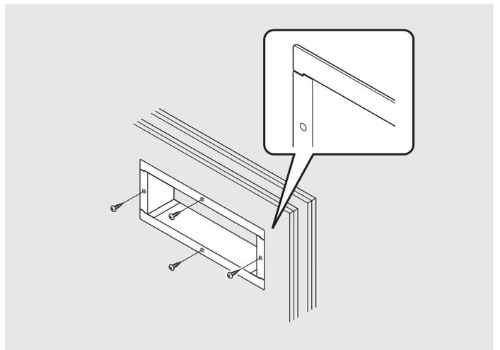
⑥ 反対側からも同様に天面板と側板Bを挿入し、付属のビスで固定してください。側板Bは側板Aの内側にはいます。
