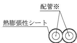
配管※ 熱膨張性シート 熱膨張性シートをまとめて巻き付ける場合(施工例1)
