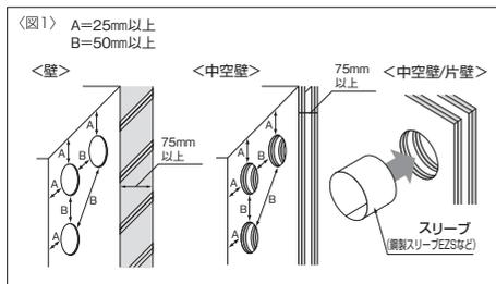
※中空壁の場合は、厚さ0.25mm以上の鋼製スリーブまたは金属板を挿入してください。(弊社製品「EZS」「EZSN」推奨)
