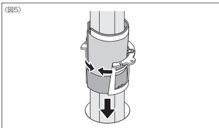
● 開口内に挿入しにくい場合は、樹脂製スリーブの受け部を折り取り、内部の金具を外側へ折り曲げてから配管束に巻き付けてください。〈図4〉
