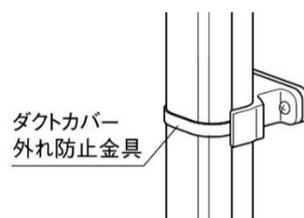
※金具を取り外す時は、図の矢印の部分押し込み、ツメが外れた状態にしてから取り外してください。無理に力を加えると、破損の原因となります。
